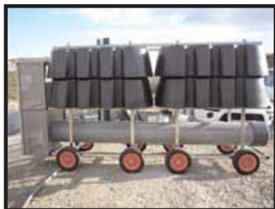
Radeau conçu avec des flotteurs CE2A et équipé d'une pompe immergée avec panier à grille inox de protection.
