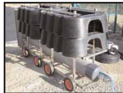
Radeau conçu avec des flotteurs CE2A et équipé d'une pompe immergée avec panier à grille inox de protection.
